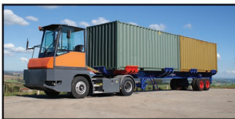
Transportando 2 contêineres de 20 pés.
